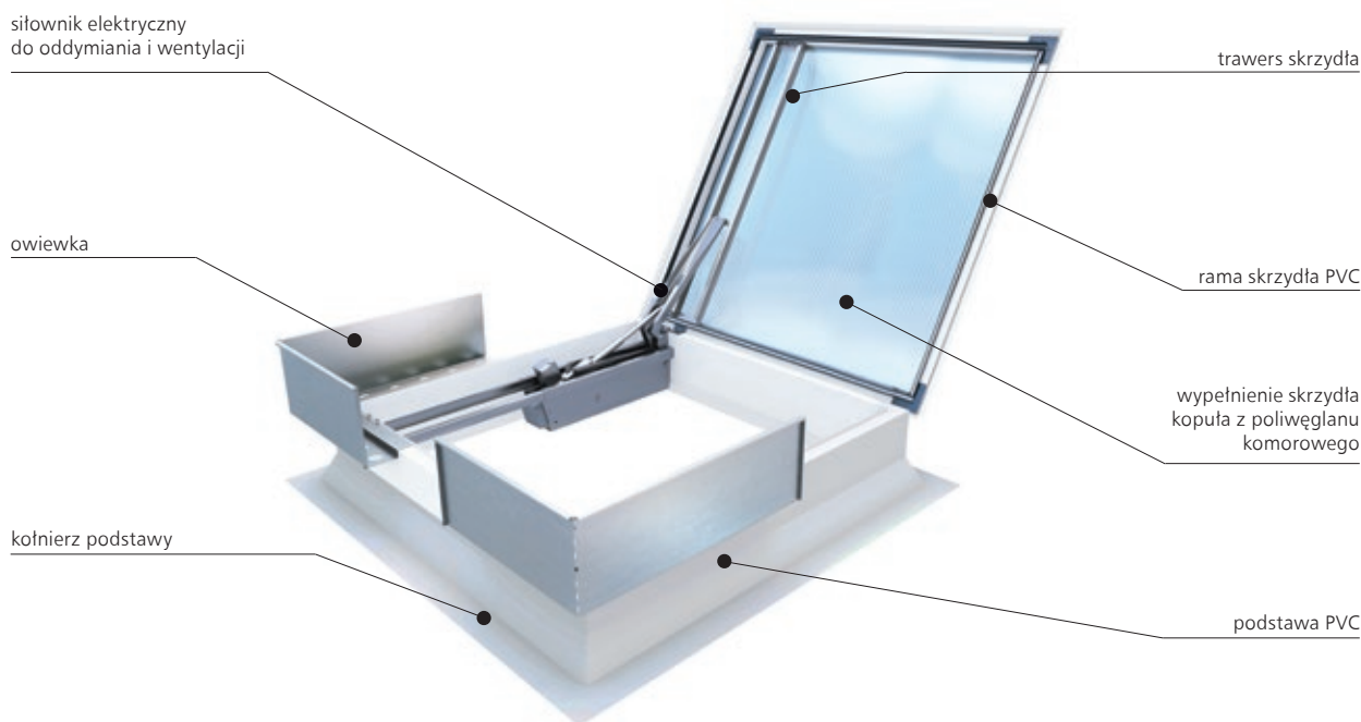
Rys. 152 – Budowa klapy oddymiającej mcr THERMOLIGHT Plus NG-A z opcją wyjścia na dach ze sterowaniem elektrycznym do oddymiania i wentylacji
